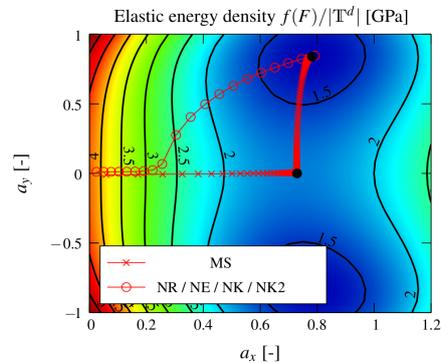
Vergleich von Optimierungsmethoden zur Minimierung der Formänderungsenergie eines Laminats<sup>a</sup>
