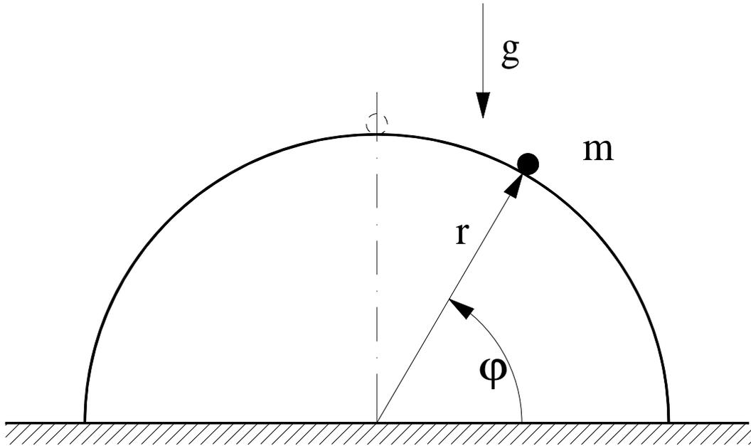
Nach einer kleinen Störung rutscht ein Massenpunkt  $m$  unter dem Einfluss der Schwerkraft ohne Anfangsgeschwindigkeit reibungsfrei vom Scheitel einer Halbkugel herab.
