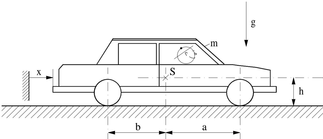
Ein Automobil mit der Masse  $m$  bewegt sich geradlinig mit der konstanten Geschwindigkeit  $v_0$ . Sein Schwerpunkt  $S$  befindet sich auf der Höhe  $h$  über der Bodenfläche. Die Abstände der Vorder- und Hinterachse des Autos von der Vertikalen, die durch den Schwerpunkt geht, sind  $a$  bzw.  $b$ .
