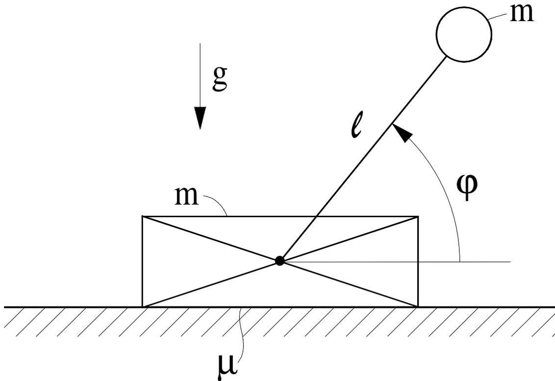
Ein masseloser Stab der Länge  $\ell$  ist an seinen Enden gelenkig mit zwei Massenpunkten  $m$  verbunden, von denen einer auf horizontaler Unterlage reibend gleiten kann. Der Stab wird in die lotrechte Ruhelage gebracht und setzt sich von dort aus durch eine kleine Störung in Bewegung.
