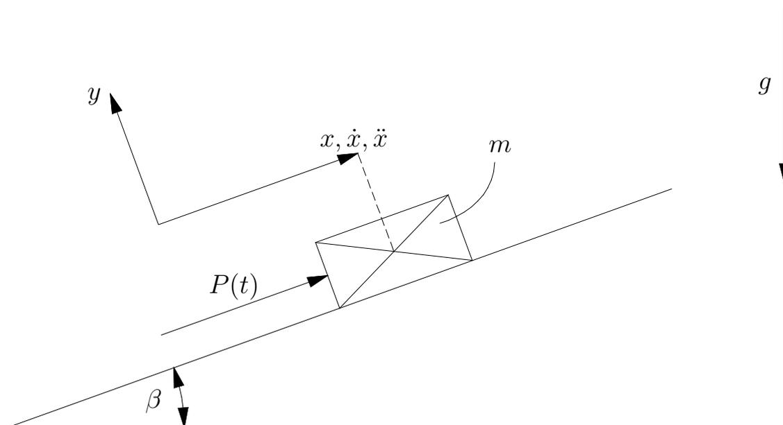
Ein Klotz der Masse  $m$  wird durch eine Kraft  $P(t) = 2mg(1 - ct^2)$  eine schiefe Ebene mit dem Steigungswinkel  $\beta$  hinaufgedrückt. Der Reibungskoeffizient zwischen Klotz und schiefer Ebene habe für Haft- und Gleitreibung denselben Wert  $\mu$ .
