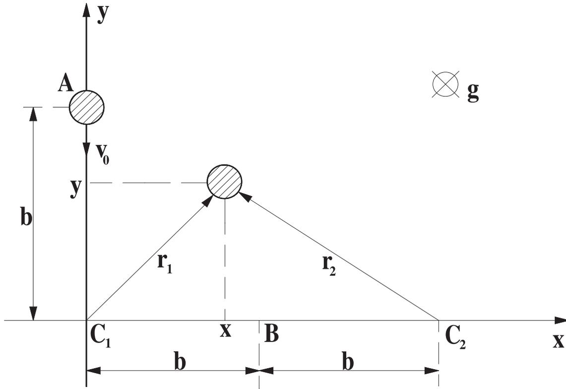
Ein in der  $x$ - $y$ -Ebene frei beweglicher Massenpunkt mit der Masse  $m$  befindet sich zum Zeitpunkt  $t_0 = 0$  in  $A(0, b)$  und hat die Anfangsgeschwindigkeit  $\underline{v}_0 = (0, -v_0)$ . In einer allgemeinen Lage wird er vom Punkt  $C_1$  mit der Kraft  $\underline{F}_1 = k_1 \underline{r}_1$  abgestoßen und vom Punkt  $C_2$  mit  $\underline{F}_2 = -k_2 \underline{r}_2$  angezogen.
